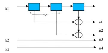
Dibujar el Trellis correspondiente a dicho esquema de codificación de canal.
