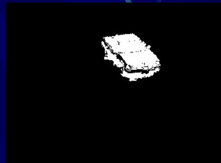
Non parametric model + shadow suppression (Elgammal)
