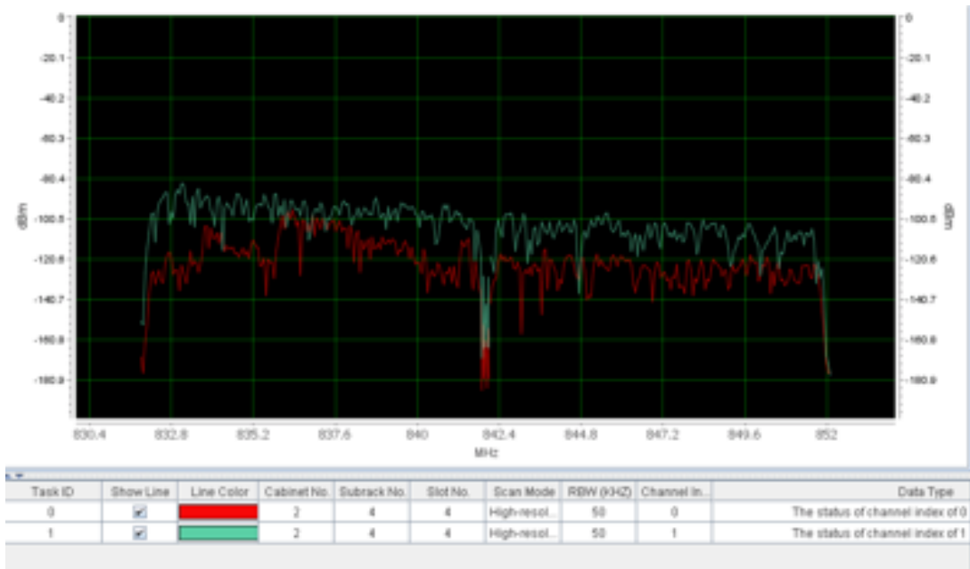
Figura 48: RSSI en LTE desigual en ambas tiradas que afecta a toda la banda
