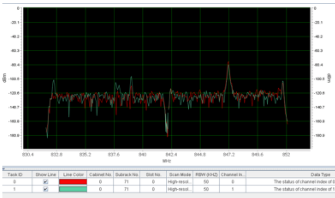
Figura 49: RSSI en LTE concentrado en una frecuencia
