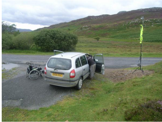
Figura 3. Ejemplo de uso de una antena WiFi portátil en una localización de campo para posibilitar la conexión con los geólogos que están en la colina.
