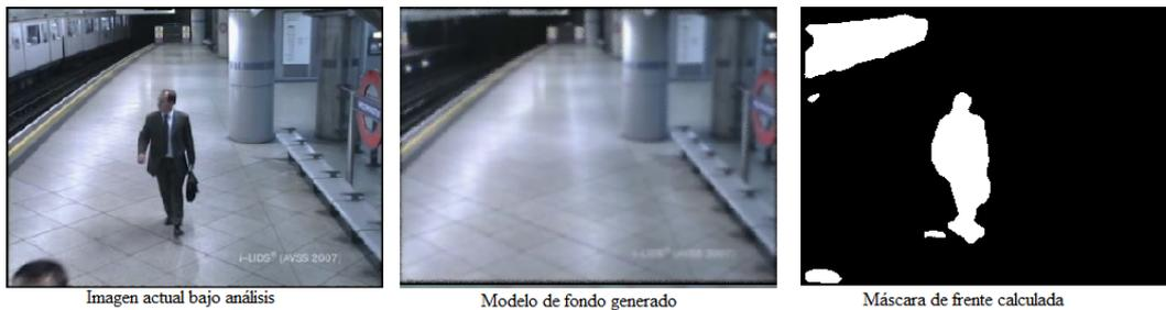
Figura 3.10: Modelo de fondo generado y máscara de frente calculada mediante el algoritmo de sustracción de fondo LOBSTER.
