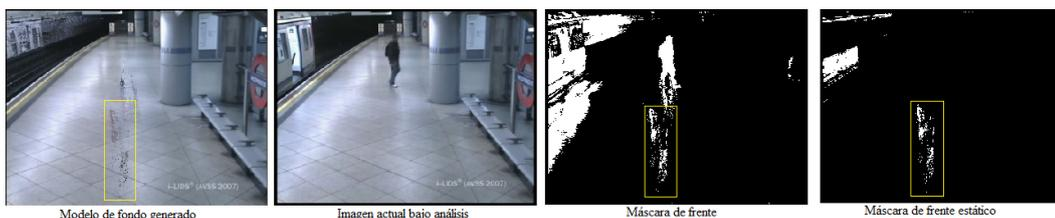
Figura 4.1: Falsos positivos detectados por errores del modelo de fondo.
