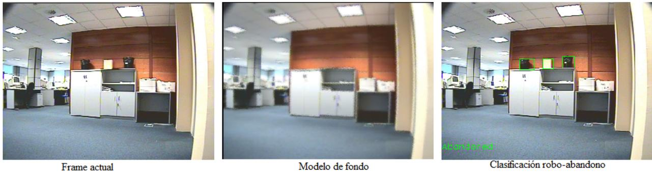
Figura 2.7: Resultados obtenidos tras aplicar un algoritmo de discriminación de robo-abandono sobre el imagen actual y el modelo de fondo de una secuencia de vídeo. De izquierda a derecha se presentan un imagen de la secuencia, el modelo de fondo generado por el algoritmo de sustracción de fondo y los objetos discriminados como abandonados por el algoritmo de discriminación utilizado.
