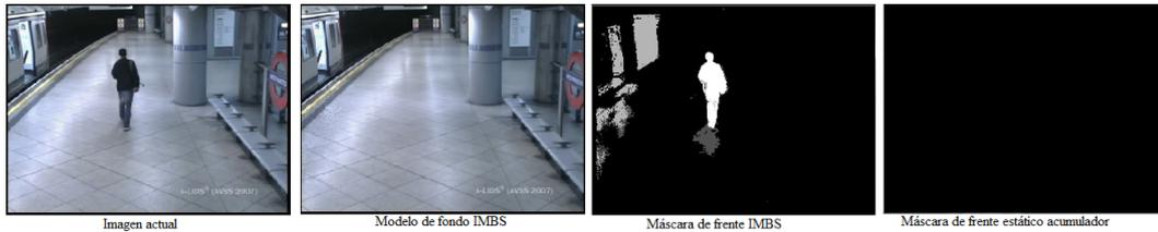
Figura 4.5: Error producido por la configuración del sustractor de fondo IMBS y el detector de regiones estáticas acumulador de máscaras de frente. Como se observa, el modelo de fondo ha absorbido el tren antes de detectarlo como estático.
