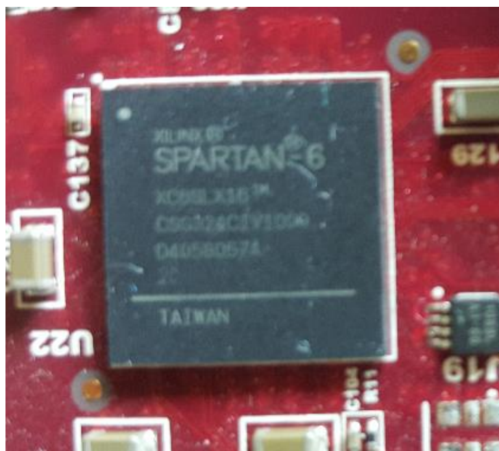
33 Fot.2: FPGA Xilinx Spartan-6 utilizada en el desarrollo del estudio
