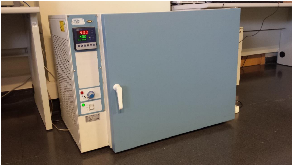
38 Fot.5: Estufa de secado y esterilización Selecta Digitherm utilizada en el desarrollo del estudio
