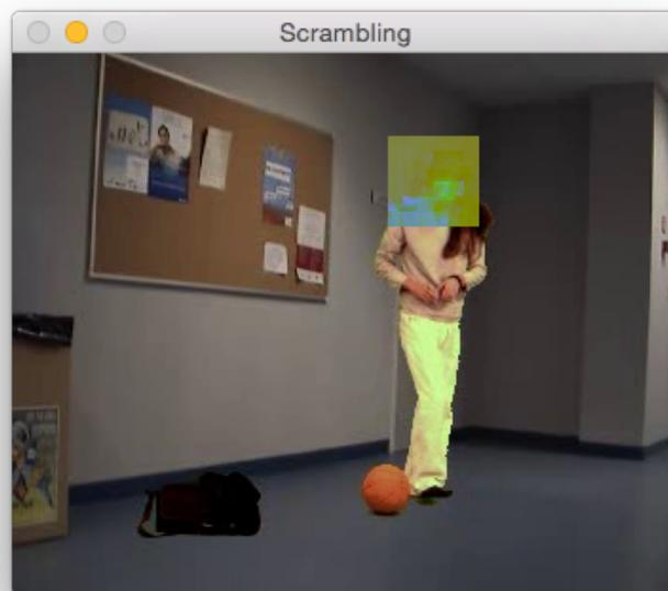
**Figura 3.7: Scrambling en las componentes YCrCb**
