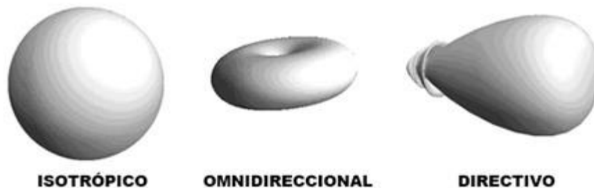
Figura 2-13: Tipos de diagramas de radiación en función de su directividad
