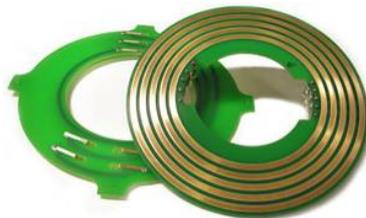
*Figura 4-3: Imagen de un anillo rotativo*
