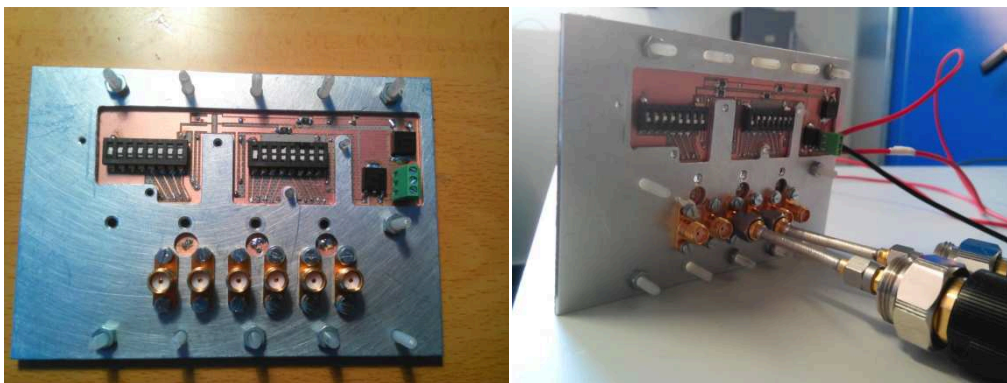
Figura 90: Fotos de montaje y medición finales para la placa de tres desfasadores
