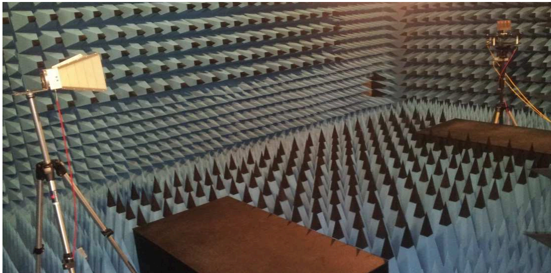
Figura 156: Proceso de medida típico enfrentando una bocina a la antena diseñada.
