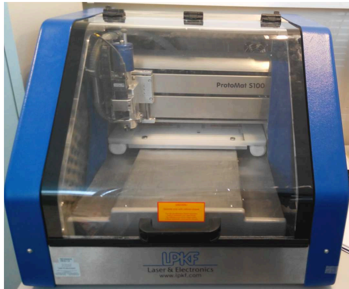
Figura 153: Máquina para la construcción de circuitos en el taller de fabricación de la EPS
