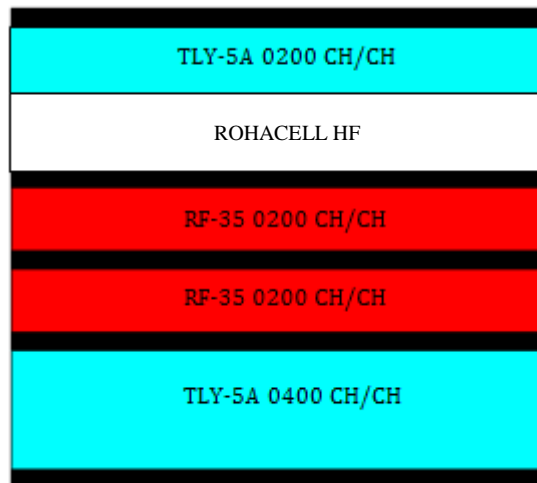
Figura 3-2: Estructura de los diferentes materiales que componen la antena
