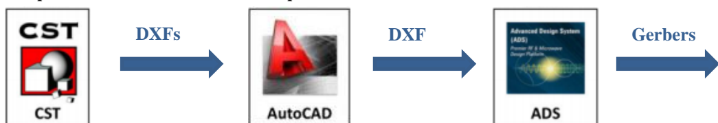
Figura A-2: Diagrama para la obtención de los gerbers
