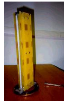
Figura 2-4: Antena de estación base de telefonía móvil
