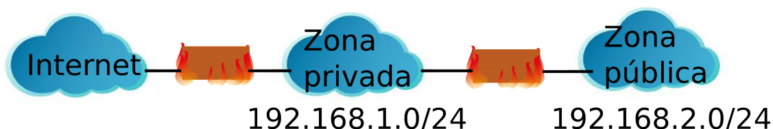
Figura 4.2: Estructura final de la red con la asignación IP. Se pueden observar las dos zonas de red interconectadas entre sí y a internet.
