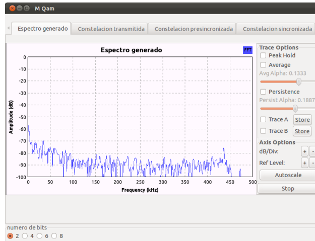
Fig 6.0.20: Espectro de la señal generada para 4-QAM
