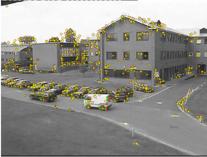
Figura 3.4. Correspondencia entre puntos característicos del frame i - 1 , círculo rojo, y del frame i , cruz verde.
