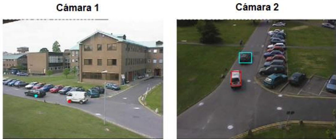
Figura 3.12. Estimación del centro de los objetos en la cámara 1 con la información de la cámara 2.
