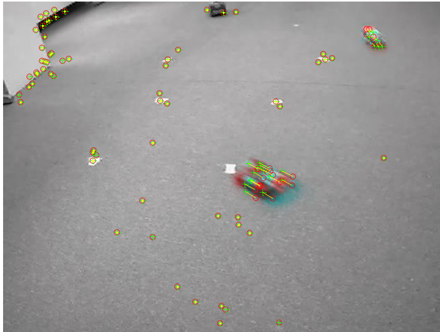
Figura 4.3. Correspondencias entre los puntos de interés del frame en el instante i-1 (círculo rojo) y en el instante i (cruz verde).
