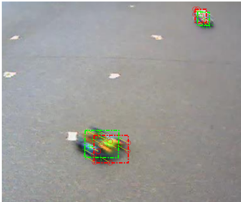
Figura 4.9. Estimación de movimiento. En rojo, box almacenado, en verde, box estimado.
