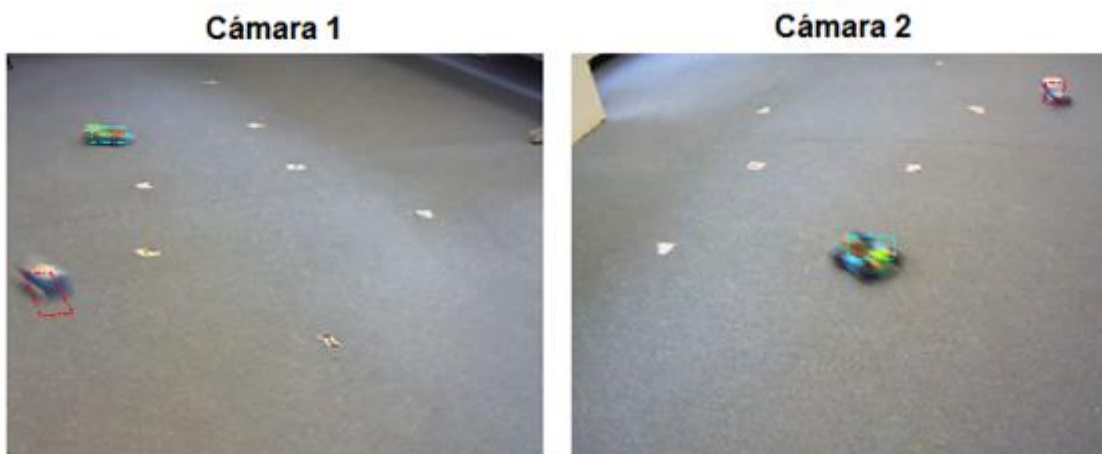
Figura 4.15. El recuadro del objeto rojo de la cámara 1 es estimado utilizando el recuadro del objeto rojo de la cámara 2.
