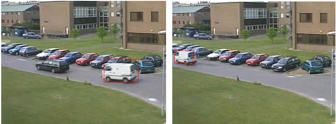
Figura 3.8. Ajuste en escala y orientación del recuadro que delimita el objeto a lo largo de la secuencia de vídeo.
