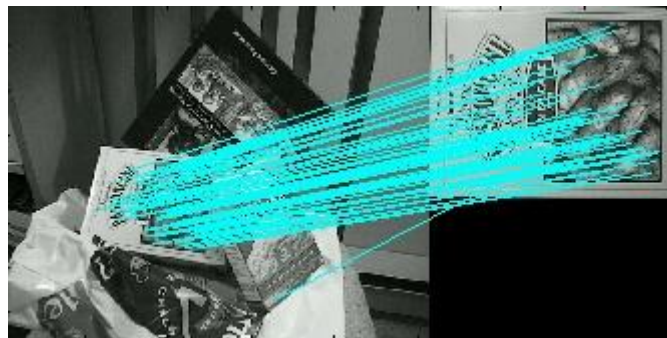
Figura 2.12. Matching entre keypoints de dos imágenes distintas. Imagen extraída de [40].
