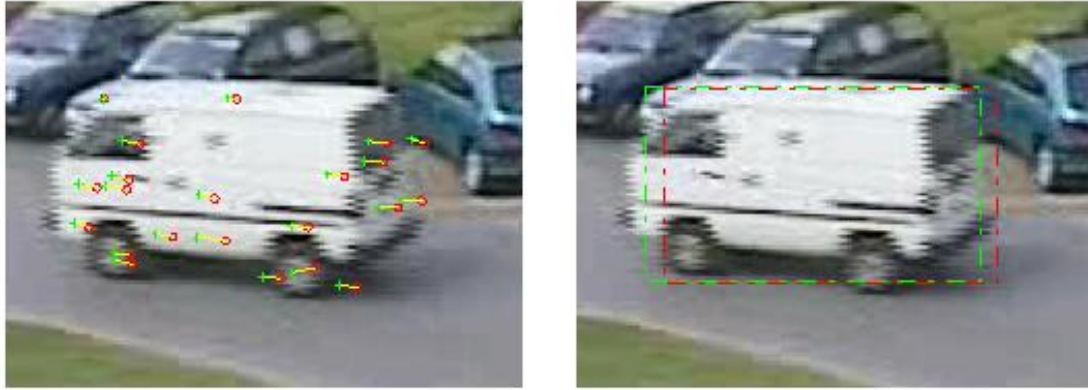
Figura 3.9. En la imagen izquierda, en círculos rojos la posición de los puntos de interés almacenados ( frame i-1 ) y en cruces verdes sus correspondencias en el frame i . En la imagen derecha, el rectángulo rojo indica el área del objeto almacenado ( frame i-1 ) y el rectángulo verde indica la posición estimada del objeto en el frame i .
