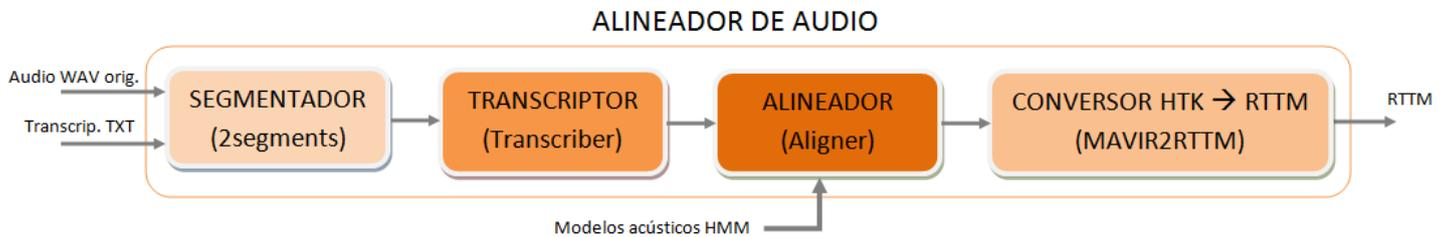
Figura 3.23: Estructura interna del alineador de audio
