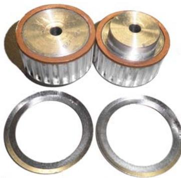
Figura 3.16: Poleas con coronas de placa de PCB, realizadas a medida.
