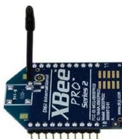
Figura 5.9: Módulo Zigbee empleado: Xbee PRO series 2, de Digi International.
