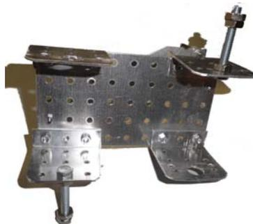
Figura 3.3: Estructura metálica diseñada. Piezas de sujeción de motores.
