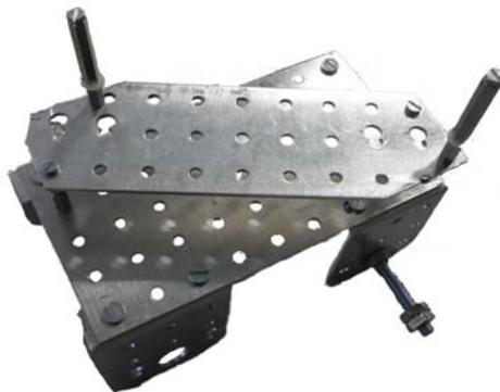
Figura 3.6: Estructura metálica diseñada. Sistema de niveles para las placas electrónicas.
