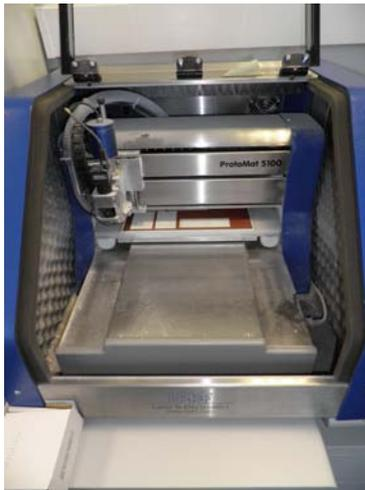
Figura 4.4: Equipo utilizado en la fabricación de placas de circuito impreso.
