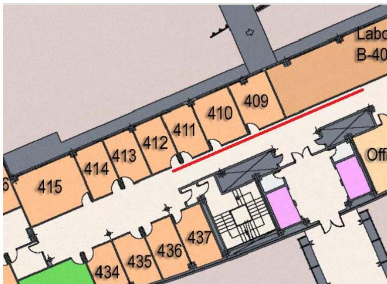
Figura 5.247: Plano del pasillo de 2 m. de ancho(0.50 m. de puertas), edificio B
