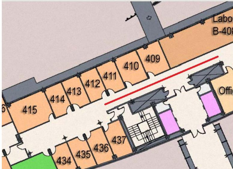
Figura 5.83: Plano del pasillo de 2 m. de ancho(1 m. de puertas), edificio B
