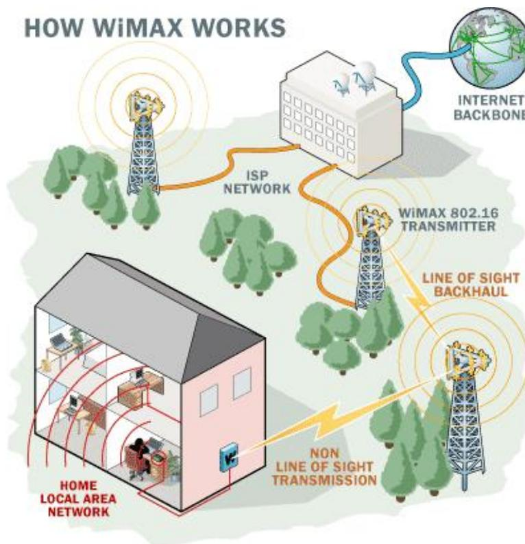
Figura 3.2: Diagrama de conexión WiMAX
