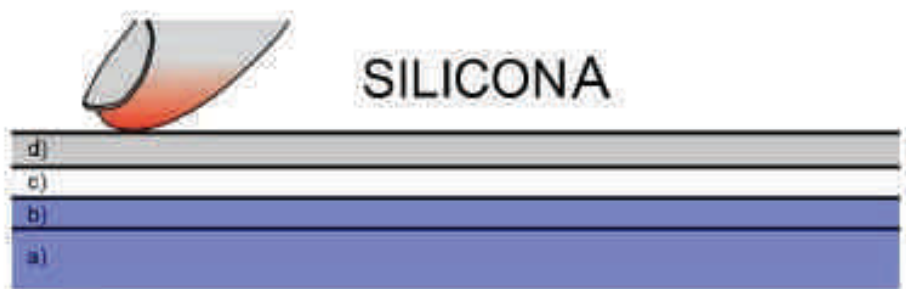
Figura 3.17: Superficie de contacto de silicona: el hueco (c) está entre la superficie de proyección (d) y la combinación de la silicona (b) y la superficie acrílica (a) (figura extraída de (10))
