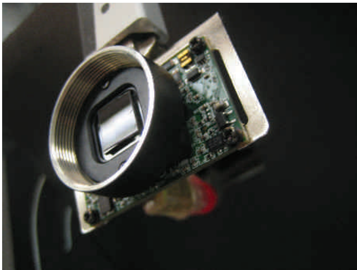
Figura 3.9: Filtro IR colocado sobre la lente
