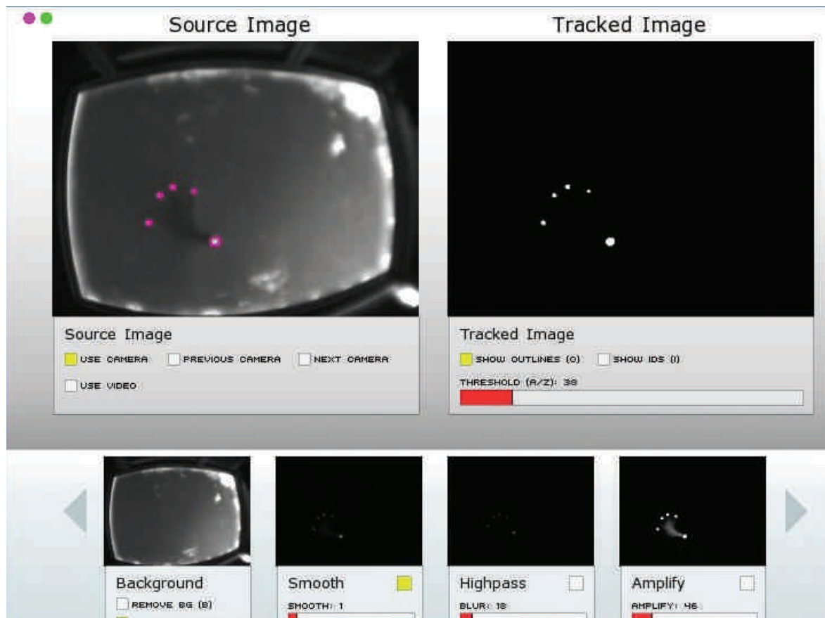
Figura 3.24: Ajuste de “Smooth”. Obtenemos una imagen de calidad al filtrar el ruido de la imagen
