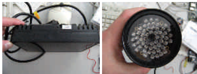
(a) Tapado del sensor de la lámpara de IR rectangular (b) Tapado del sensor de la lámpara de IR circular
