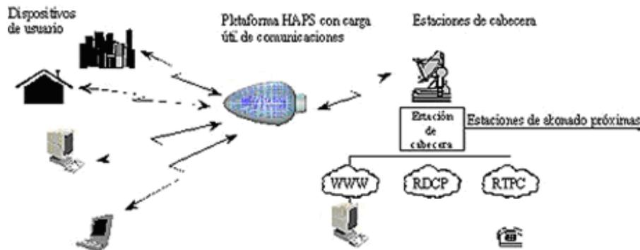
Figura 4-2: Configuración de la red.
