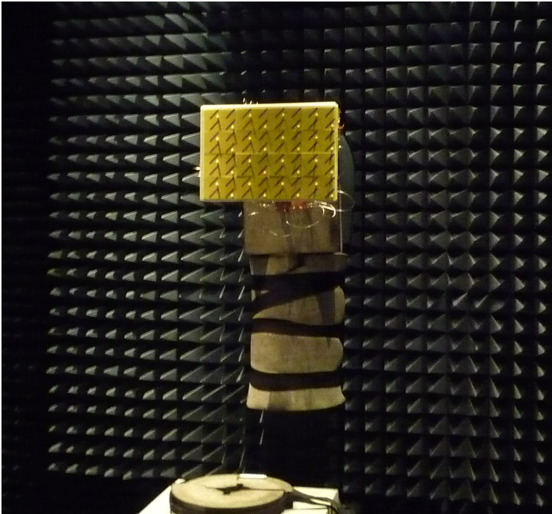
Figura 4-19 Sistema en configuración circular montado en la cámara anecoica de la ETSIT-UPM
