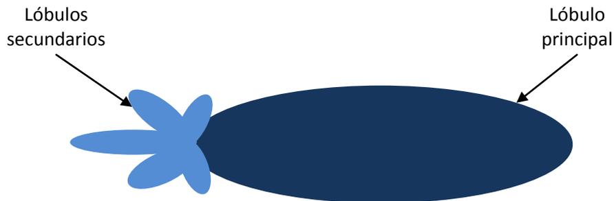
Figura 3.3 - Patrón de radiación azimuth
