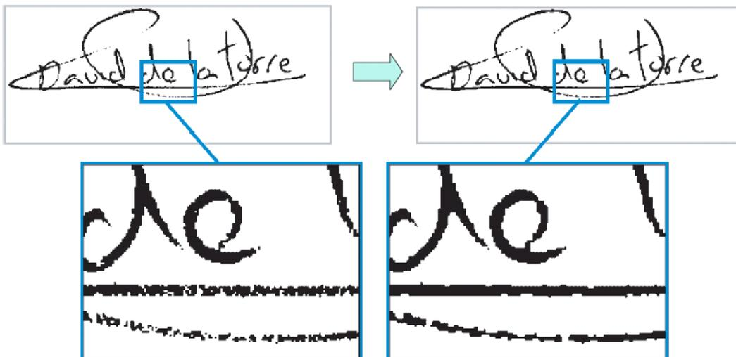
**Figura 26.** Eliminación de ruido tras efectuar una apertura seguida de cierre.
