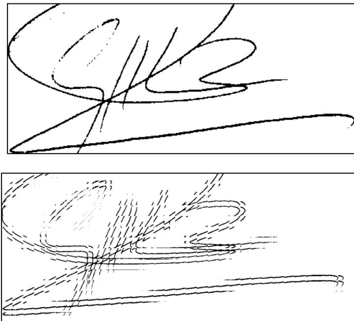
**Figura 24.** Ejemplo de aplicación de una ventana deslizante a una firma (firma de 512x218, ventana de 32x32 con solape del 50%).
