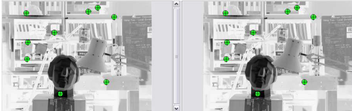
FIGURA 41 : "TSUKUBA" SELECCIÓN DE PUNTOS HOMÓLOGOS MEDIANTE SURF.
