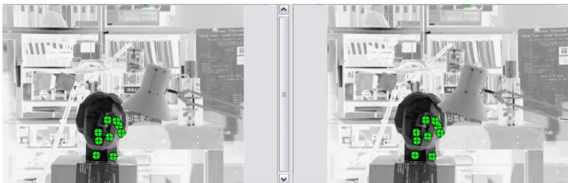
FIGURA 44 : "TSUKUBA CAPA DEL BUSTO" SELECCIÓN DE PUNTOS HOMÓLOGOS MEDIANTE SURF.
