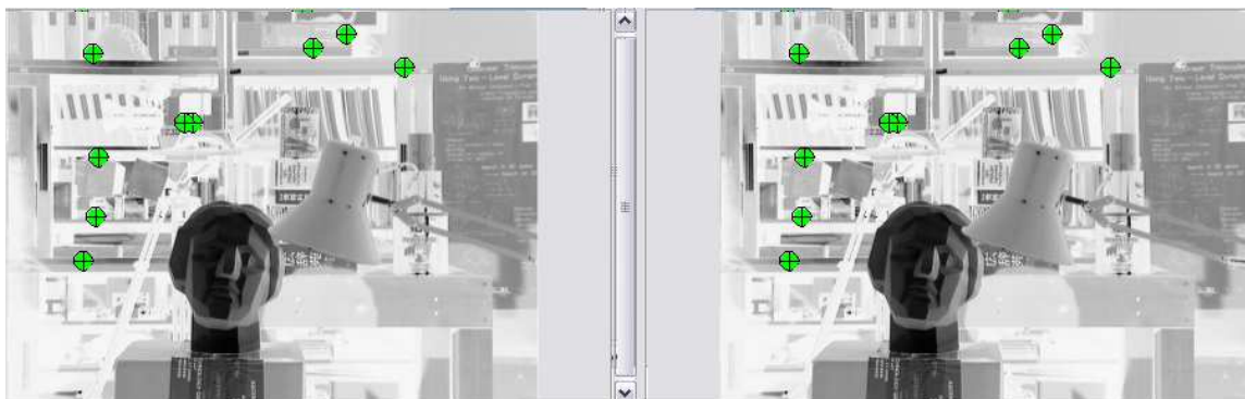
FIGURA 42 : "TSUKUBA CAPA DEL FONDO" SELECCIÓN DE PUNTOS HOMÓLOGOS MEDIANTE SURF.
