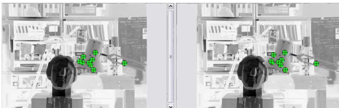
FIGURA 47 : "TSUKUBA CAPA DE LA LÁMPARA CON MAYOR SELECCIÓN DE PUNTOS CARACTERÍSTICOS" SELECCIÓN DE PUNTOS HOMÓLOGOS MEDIANTE SURF.
