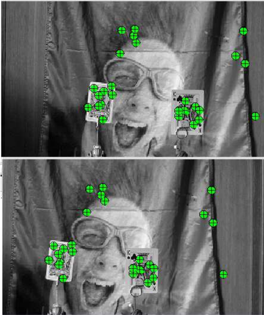
FIGURA 97 : "CARTAS" REDUCIDAS. EXTRACCIÓN DE PUNTOS DESPUÉS DE EXTRAER LAS CAPAS CON EL MAPA DE PROFUNDIDAD REAL. (CÁMARA IZQUIERDA ARRIBA Y CÁMARA DERECHA ABAJO).
