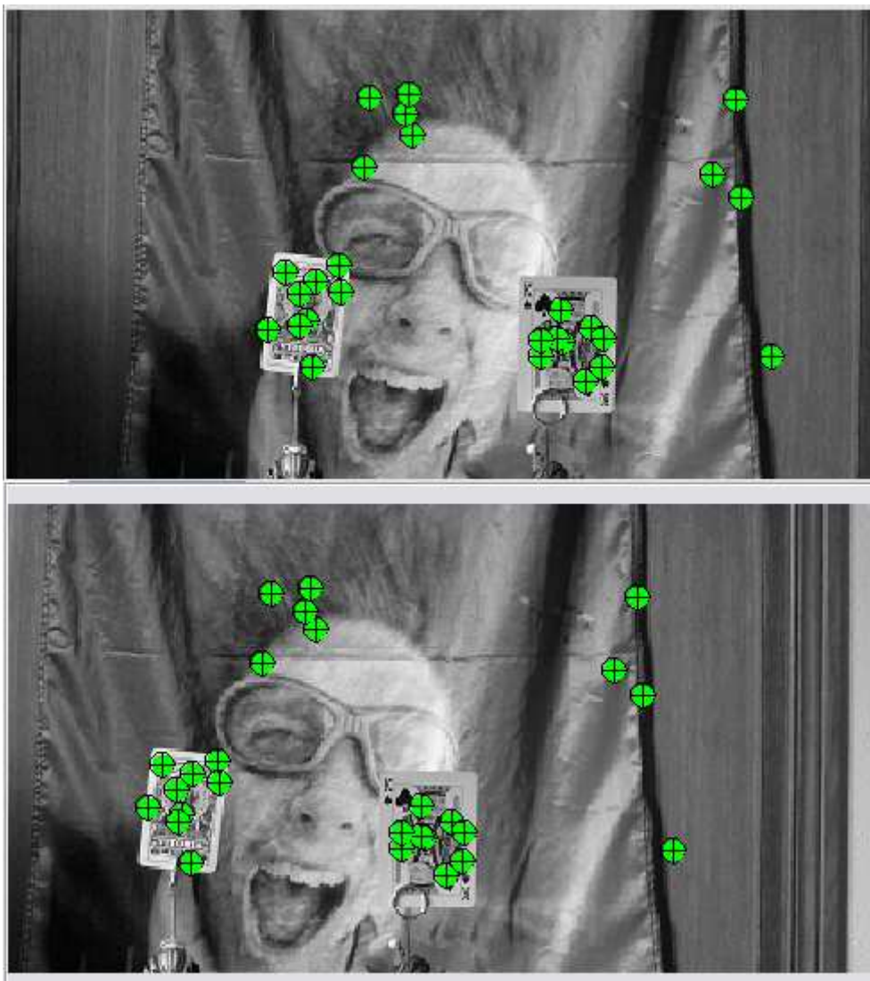
FIGURA 82 : "CARTAS" REDUCIDAS. SELECCIÓN DE PUNTOS MEDIANTE SURF. LA IMAGEN SUPERIOR CORRESPONDE CON LA CÁMARA IZQUIERDA Y LA INFERIOR CON LA DERECHA.
