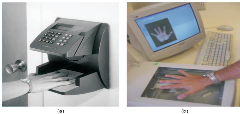
Figura 3.4: Sistemas de adquisición basados en escáner. (a) Sistema comercial con topes de posicionamiento. (b) Adquisición con un escáner de sobremesa libre de topes.
