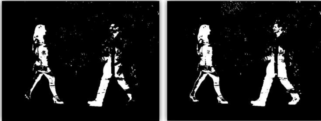
Figura 49: A la izquierda se muestra la máscara obtenida mediante el método basado en la Gaussiana Simple y a la derecha la obtenida con el método propuesto.
