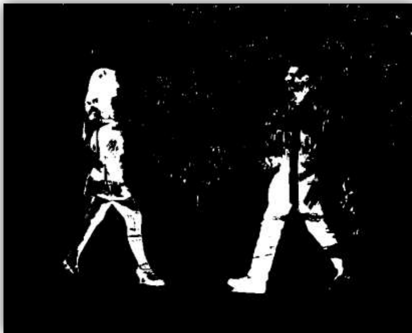
Figura 30: Segmentación mediante SG con k = 3 .
