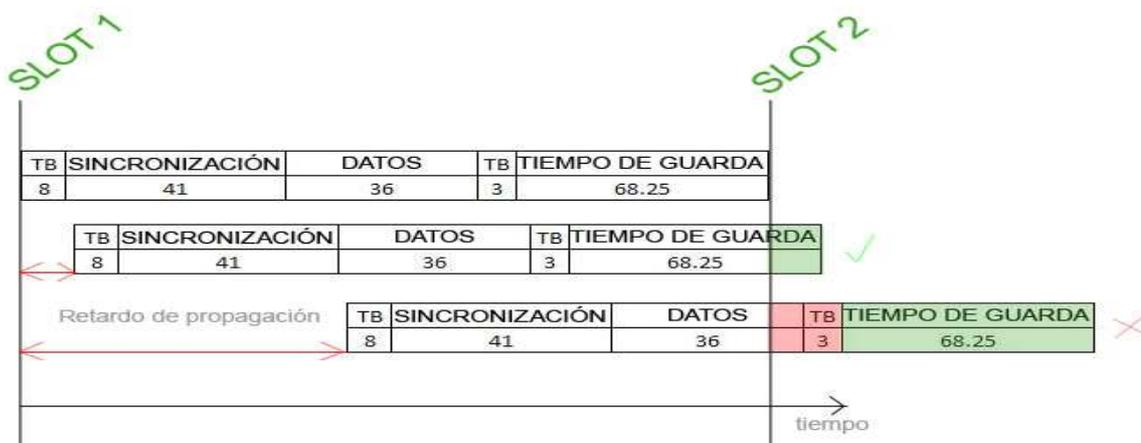
Figura 12: Ejemplo temporal de la llegada de varias ráfagas.
