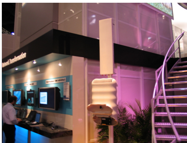
Figura B- 13: Estación base WiMAX de Alcatel-Lucent en un entorno real.
