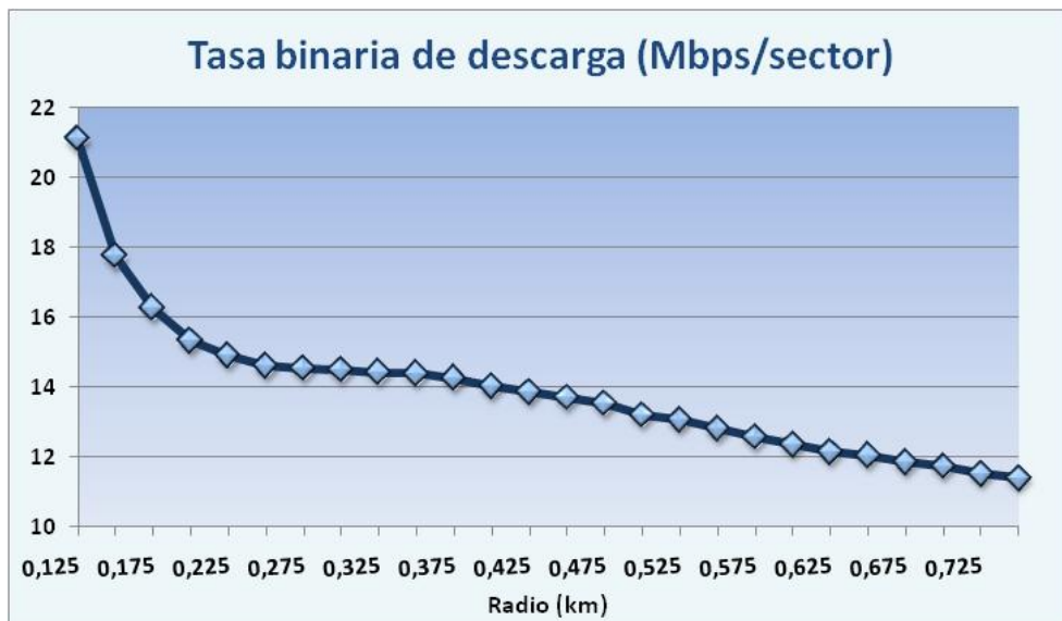
Figura A- 8: Tasa binaria de descarga para una altura de antena de receptora de 25 metros en una zona urbana.
