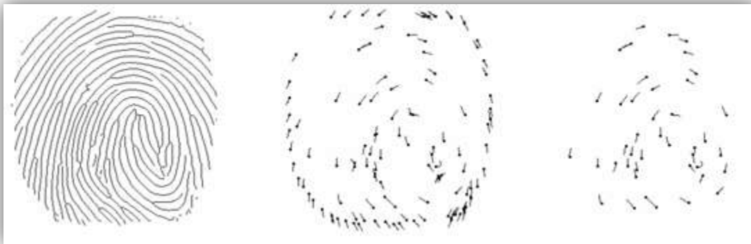
Figura 22: Mapa de crestas adelgazadas (izquierda), minucias extraídas de la huella adelgazada (centro), minucias válidas tras el post-procesado (derecha).
