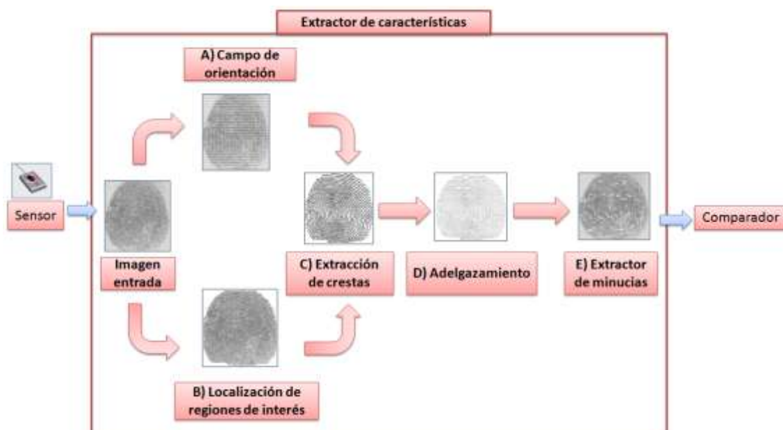
Figura 16: Módulos del extractor de características de un sistema típico de reconocimiento de huella dactilar basado en minucias.
