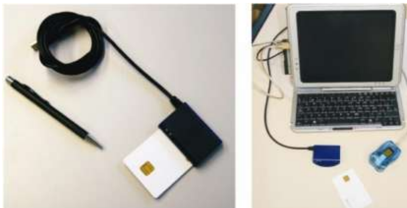
Figura 28: Sistema Match-on-Card empleado en el proyecto. Nótese en la fotografía de la izquierda que la tarjeta inteligente ha sido insertada al revés para poder observar el chip.
