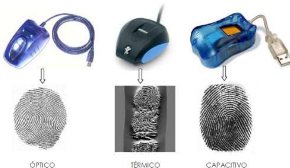
Figura 15: Sensores óptico (Fx2000 de Biometrika), térmico de desplazamiento (de Yubee) y capacitivo (TCRU1C de UPEK), y ejemplos de huellas capturadas con dichos sensores.
