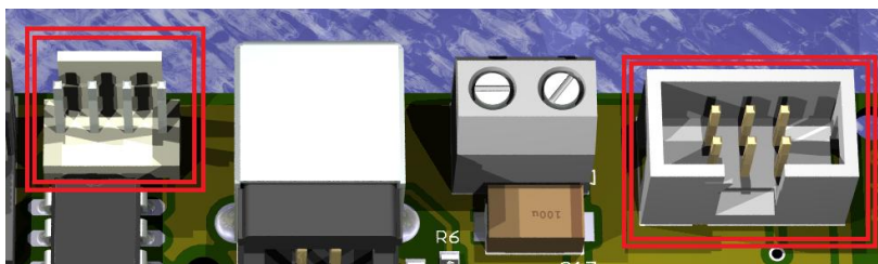
Figura 5-30: SPI e I 2 C del modelo B del módulo de comunicaciones
