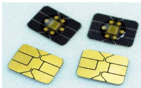
Figura 4.23: Chip de una tarjeta inteligente.
