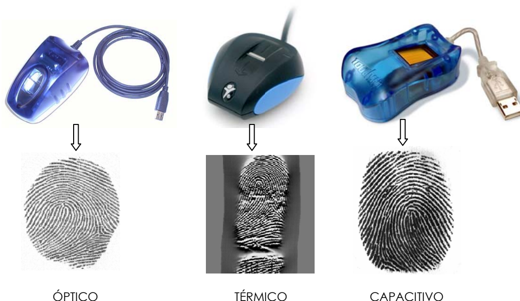
Figura 14: Sensores óptico (Fx2000 de Biometrika), térmico de desplazamiento (de Yubee ) y capacitivo (TCRU1C de UPEK ), y ejemplos de huellas capturadas con cada uno de ellos.
