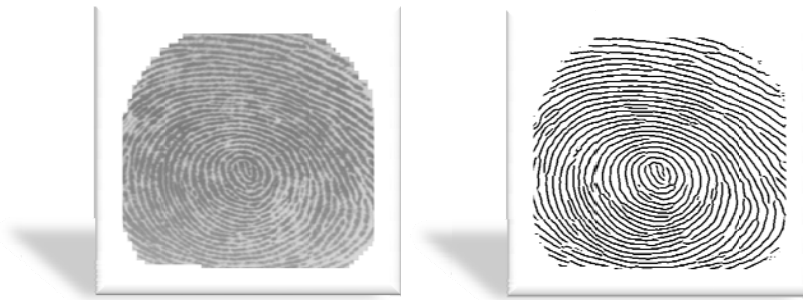
Figura 20: Ejemplo de huella antes (izquierda) y después (derecha) de la binarización. Imágenes extraídas de (4).
