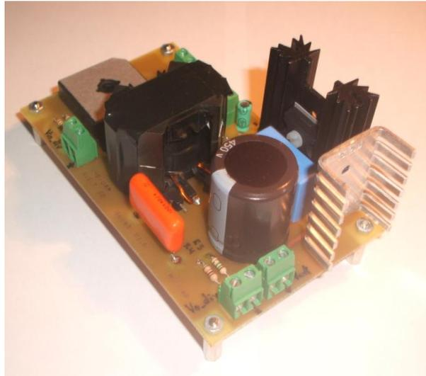
Figura 4.5: Fotografía del prototipo de boost construido
