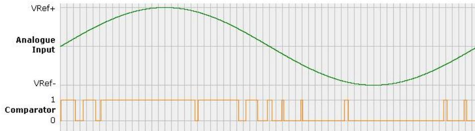
Figura 3.5: Señal sinusoidal modulada sigma-delta
