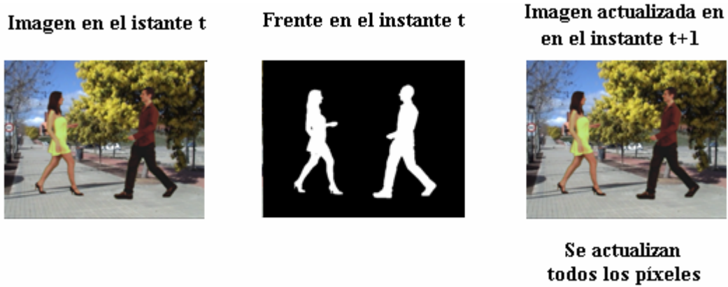
Figura 2-6: Ejemplo de la actualización a ciegas sobre una secuencia de video en el instante t.
