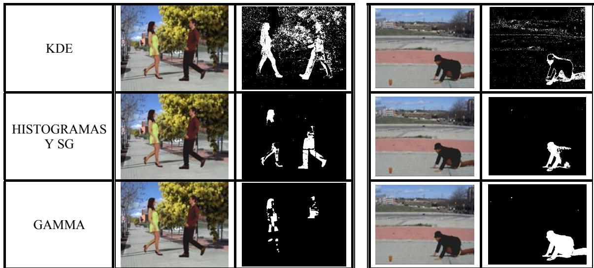
Figura 5-24: Imagen y Frentes obtenidos con los distintos métodos de segmentación de objetos sobre dos de las secuencias del banco de pruebas: Baile 2(multimodal) y Hambre (unimodal).
