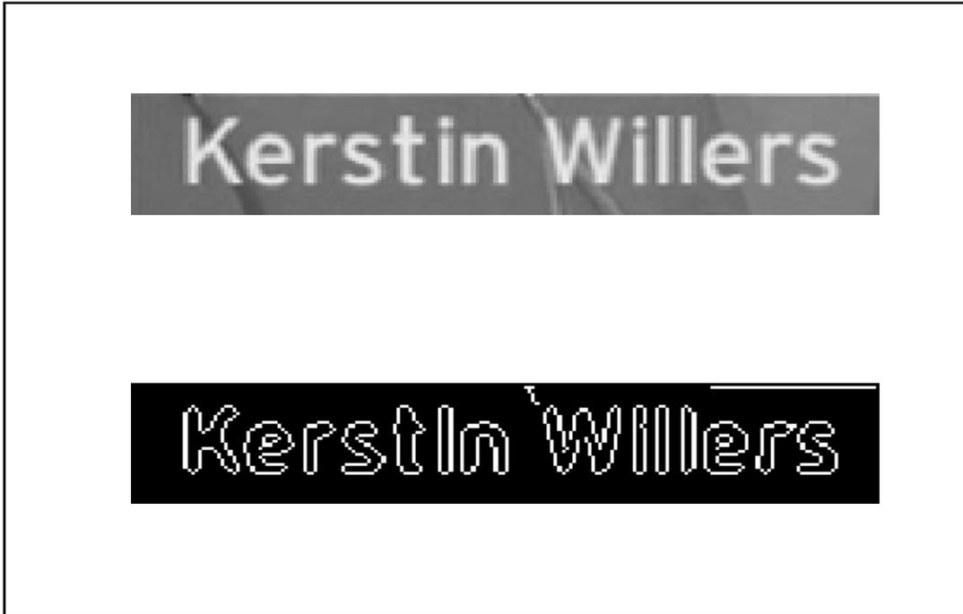
**Figura 3.2.4. Imagen original e imagen filtrada con filtro detector de bordes de Canny.**
