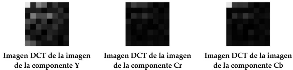
**FIGURA 3-18: Imágenes de bloques DCT Y, Cr y Cb**
