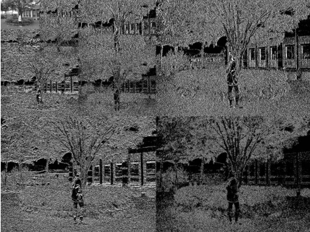
FIGURA 2-7: Transformada Haar de 3 niveles de una imagen nítida
