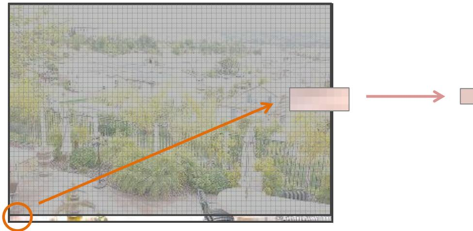
**FIGURA 4-12:** Las 403 filas de la imagen no son divisibles en bloques de 8x8 píxeles. Las tres últimas filas se agrupan en bloques de 3x8 píxeles, a los que se les aplica el Color Medio
