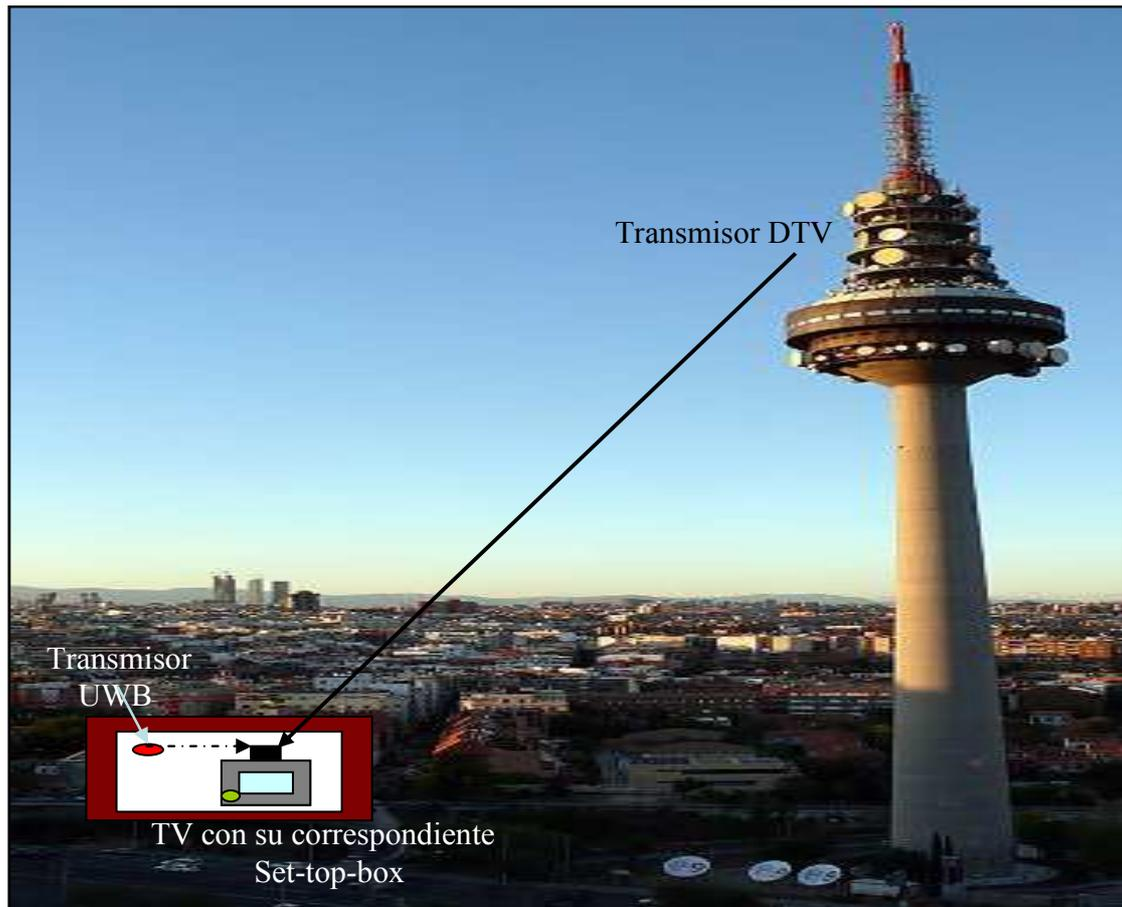
**Figura 4.15:** Ejemplo de cobertura para un sistema TDT en Madrid (Emisión desde Torrespaña) con una fuente interferente UWB en la misma localización que el receptor. El receptor es una televisión analógica acompañada por un set-top-box o decodificador digital, necesario para poder recibir la señal digital terrenal [36].
