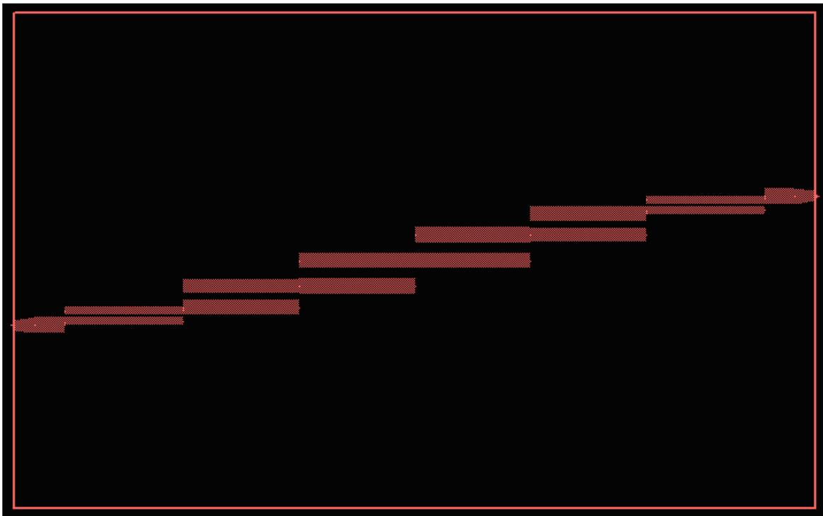
**Figura 6-21:** Layout del filtro paso banda de líneas acopladas terminadas en abierto centrado en 1.8 GHz en microstrip.
