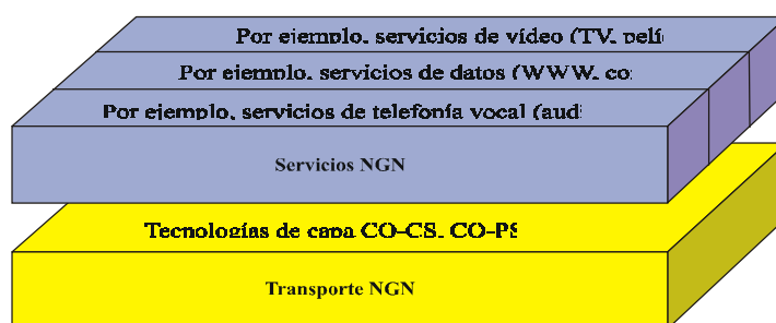
Figura 3-2: Separación entre servicios y transporte en las NGN
