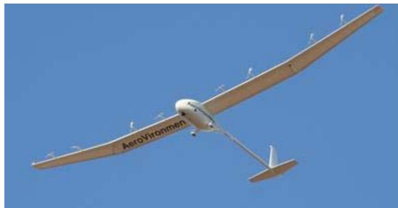
**Figura 59: Avión no tripulado basado en hidrógeno (Global Observer).**
