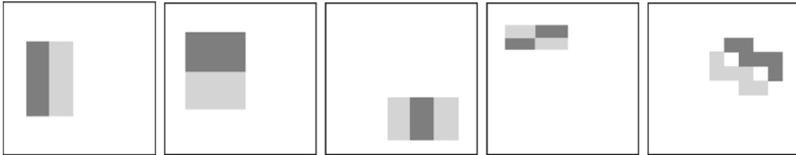
Figura 4-5 (extraída de [26]): Conjunto de filtros rectangulares empleados por [47] para extraer las características necesarias del algoritmo Adaboost. Cada filtro se compone de tres regiones: blanca, gris claro y gris oscuro, con sus pesos asociados 0, -1 y 1 respectivamente. Estos filtros se convolucionan con la imagen para obtener la característica buscada.
