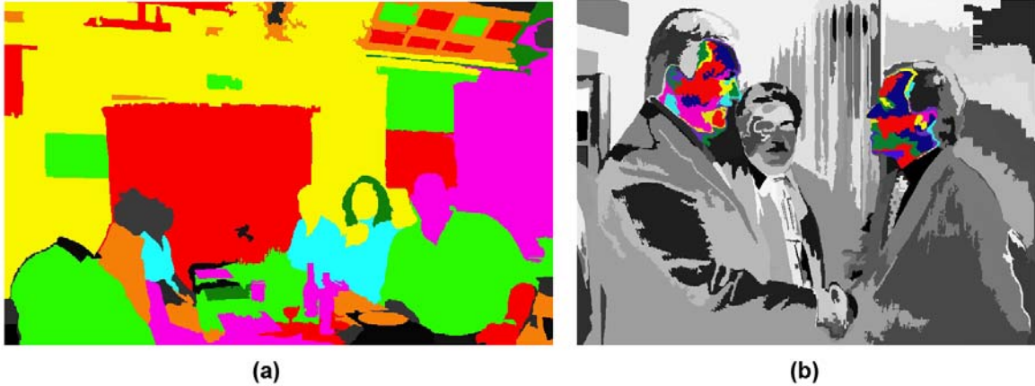
Figura 2-5: Ejemplos de una segmentación inadecuada. (a) Baja segmentación, (b) Sobre-segmentación.
