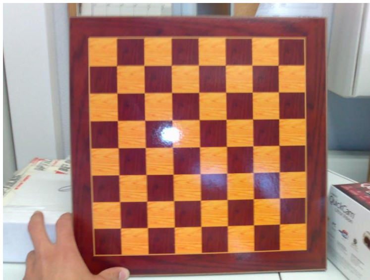
Ilustración 38 : Estructura utilizada para el cálculo de los parámetros de distorsión radial
