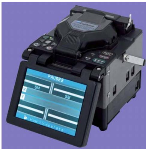
La máquina de fusión de fibra óptica FSM-50S, de FUJIKURA, utilizando el sistema de alineación PAS (Profile Alignment System) mejorado, realiza fusiones de fibra óptica de alta calidad.
