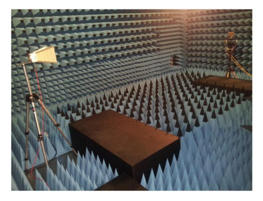
En la actualidad la Cámara Anecoica de la EPS se encuentra correctamente configurada para trabajar en frecuencias inferiores a los 10 GHz, y en fase de pruebas para su funcionamiento en un rango de frecuencias mayor (hasta 20 GHz). Cuenta con
