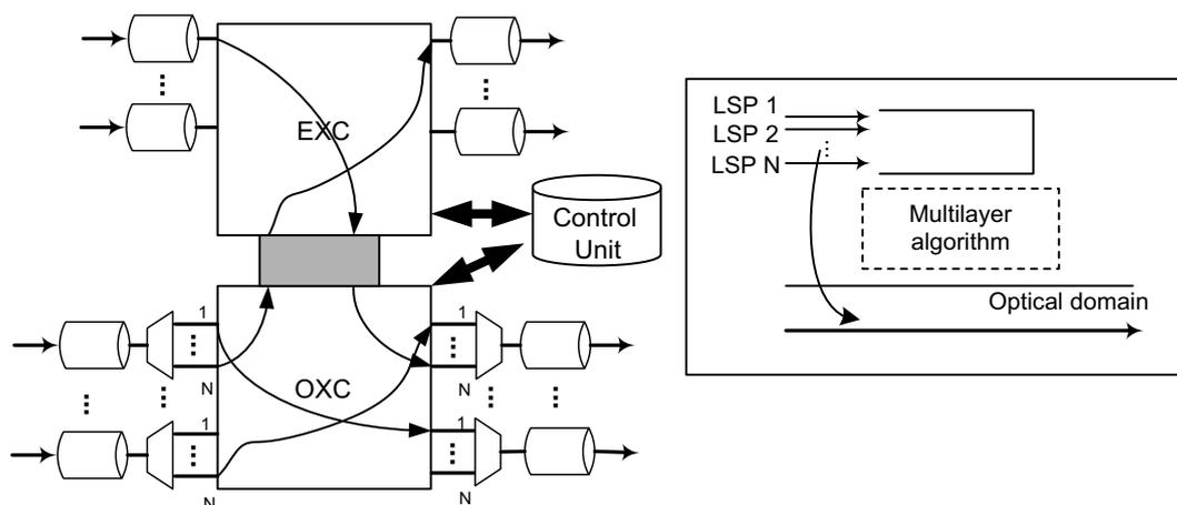
Fig. 1. Multilayer-capable router scenario.
