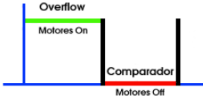
Figura 5.1: Diagrama de alimentación del motor por unidad de tiempo T
