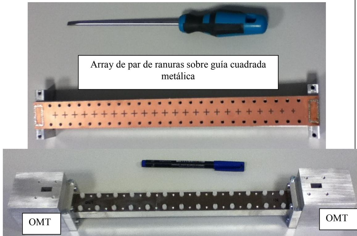
Sin embargo, se han visto algunas limitaciones derivadas de la utilización de guías metálicas cuadradas, que afectan a las prestaciones de la antena. Para corregir estas limitaciones, reducir el coste, peso y mejorar la integración con los subsistemas receptor o transmisor, se propone en este proyecto rediseñar la agrupación de ranuras sobre una guía cuadrada rellena completamente de dieléctrico.
