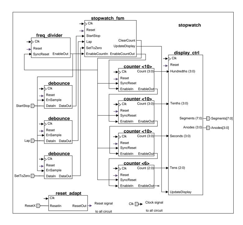
Un bloque de división de frecuencia (*freq\_divider*) se encarga de dividir por 500000 el reloj de 50 MHz de la placa para dar un ciclo cada centésima de segundo. A partir de esta base de tiempos, cuatro contadores en cascada (*counter*) proveen la cifra de centésimas de segundo (*hundredths*), décimas de segundo (*tenths*), unidades de segundo (*seconds*) y decenas de segundo (*tens*). Los contadores son instancias de un contador genérico que puede ser parametrizado para contar entre 0 y (N-1).
